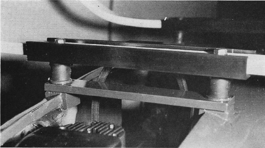
Das ist die im Text beschriebene Aluminiumbrücke zwischen den beiden vorderen Schwinggummibefestigungen. Das Kunststoffstück braucht man nicht unbedingt, man kann die Streben auch direkt mit genau in der Länge passenden Schrauben in den Gummischwingelementen befestigen. Der Anlasseriemen wird dann in den Rumpf gesteckt.
